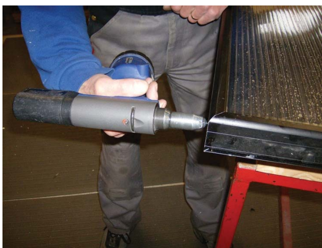
20. Remachar el listón insertado desde los listones laterales.
