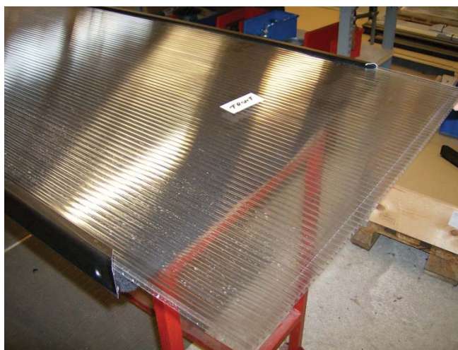
18. Insertar la cubierta. No olvidar poner la parte marcada en el exterior.
