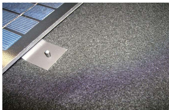
17. El remache tiene que pasar por el soporte de la célula solar.
