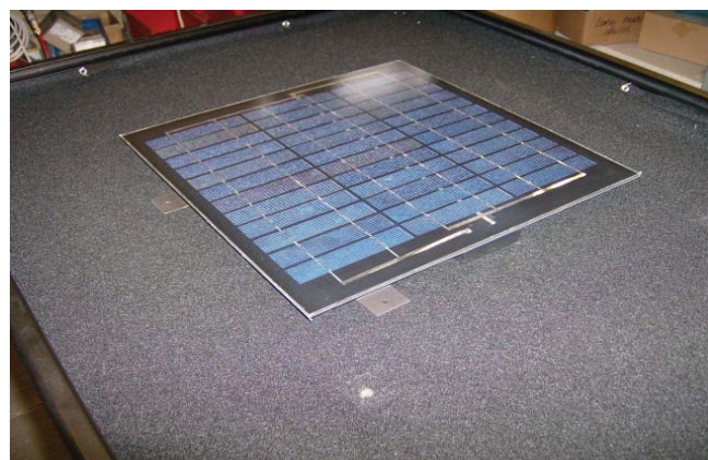
11. Remplazar la “antigua” célula por la nueva célula solar poli-cristalina (azul).
