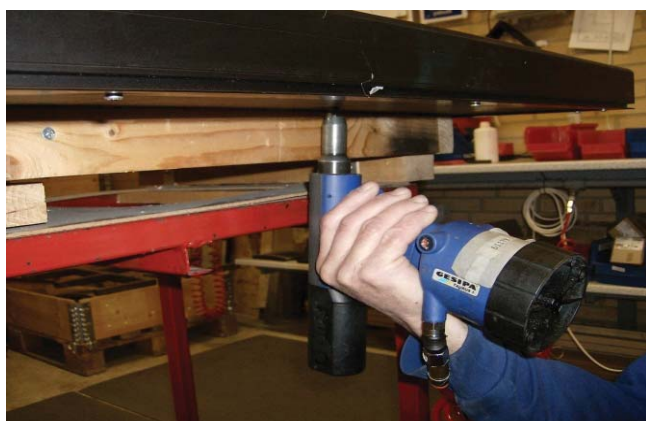
16. Colocar los remaches desde la parte posterior del panel.
