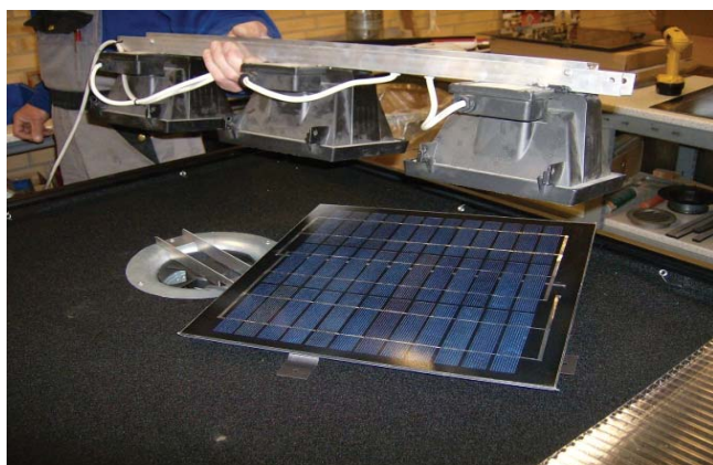
14. Comprobar que la nueva célula funciona.
