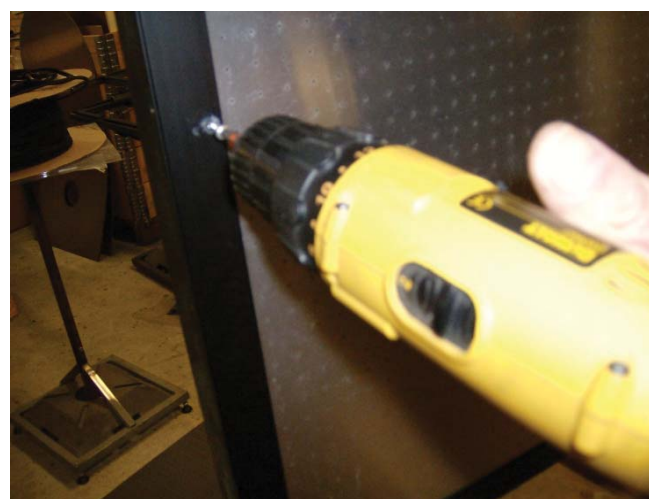
21. Atornillar la parte trasera del panel.
